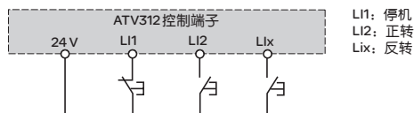
3线控制接线图
